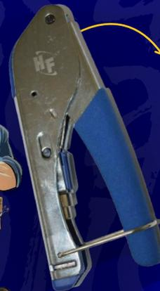
Ferramenta utilizada especialmente para prensar terminais pré-isolados dos mais diferentes tipos de conectores tubulares e de diversas seções, - Serve para apertar as seções dos fios juntamente com o revestimento do conector.
