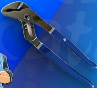
A ponta desse alicate é ajustável, ou seja, ele oferece uma maior amplitude de abertura. Além disso, o alicate bomba d'água conta com pequenos dentes no mordente e tem um formato curvado, que se assemelha a um bico de papagaio.
